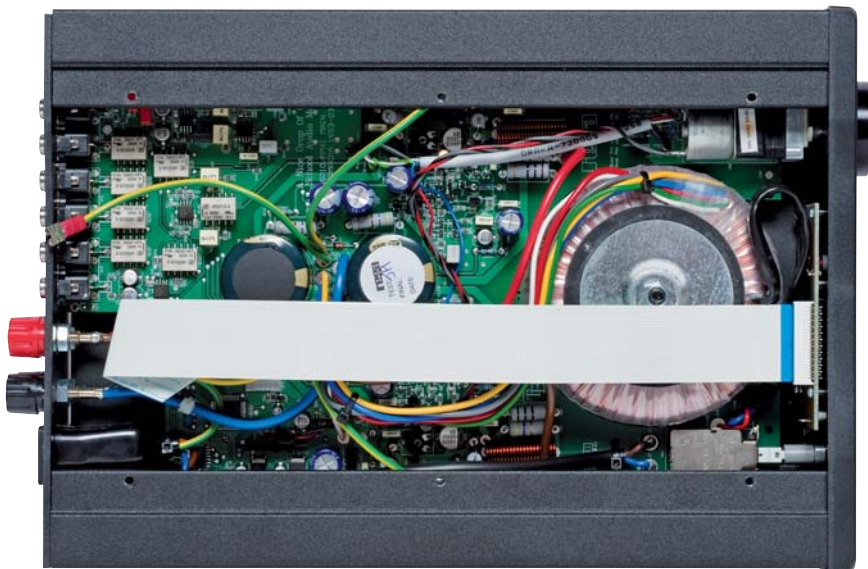
L'agencement interne est parfaitement géré. La section phono RIAA est située en haut à gauche au plus près de l'entrée 1 et au plus loin du transformateur.
